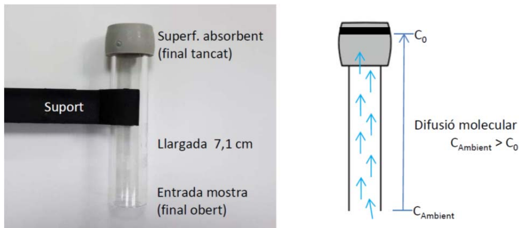
Figura 1: Principi de funcionament dels tub passius de difusió de NO 2 de tipus Palmes, on C_{\text{Ambient}} és la concentració de la mostra ambient i C_0 és la concentració a la superfície de l'absorbent.
