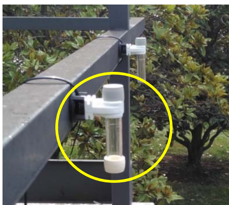
Figura 2: Imatge esquerra: Detall del tub de control. Imatge dreta: Situació del tub de control a l'Estació de la XVPCA al CEIP Josep Pla de Sant Andreu de la Barca.
