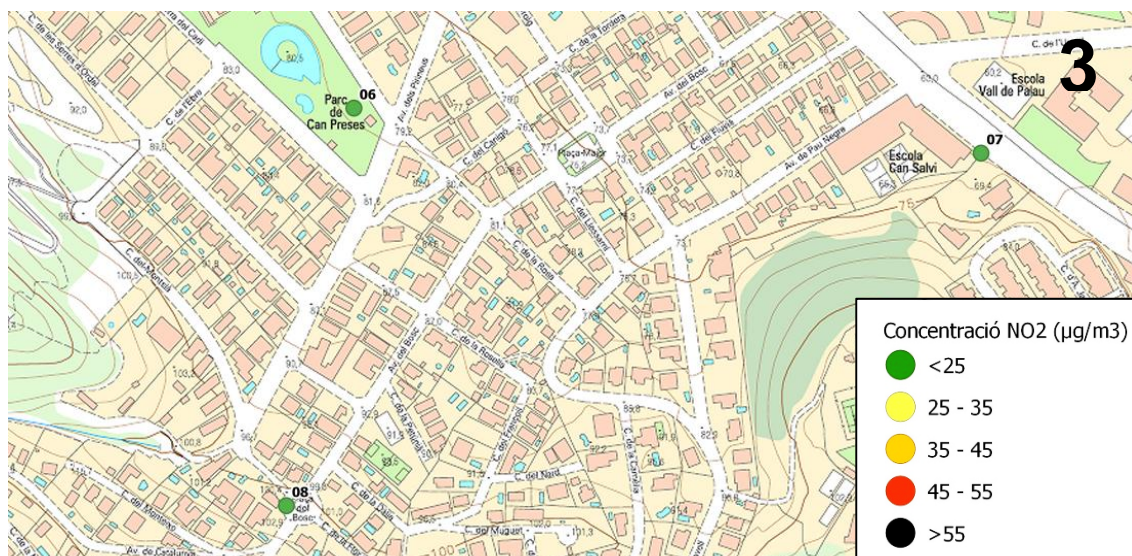
Figura 10: Plànol 3 amb indicació del punt i color en funció de la concentració d'NO 2 .
